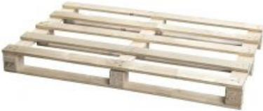
Diese gebrauchte Einwegpalette aus Holz ist mit fünf Deckbrettern und drei Zwischenbrettern ausgestattet. Sie hat 3 Unterbretter und ist eine 4 Wege Palette, das heißt, sie kann von allen vier Seiten mit einem Gabelstapler oder einem Hubwagen aufgenommen werden.
